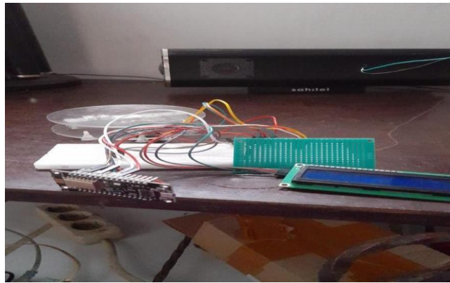
Konfigurasi antara NodeMcu, LCD, HX711, dan Sensor Load Cell
