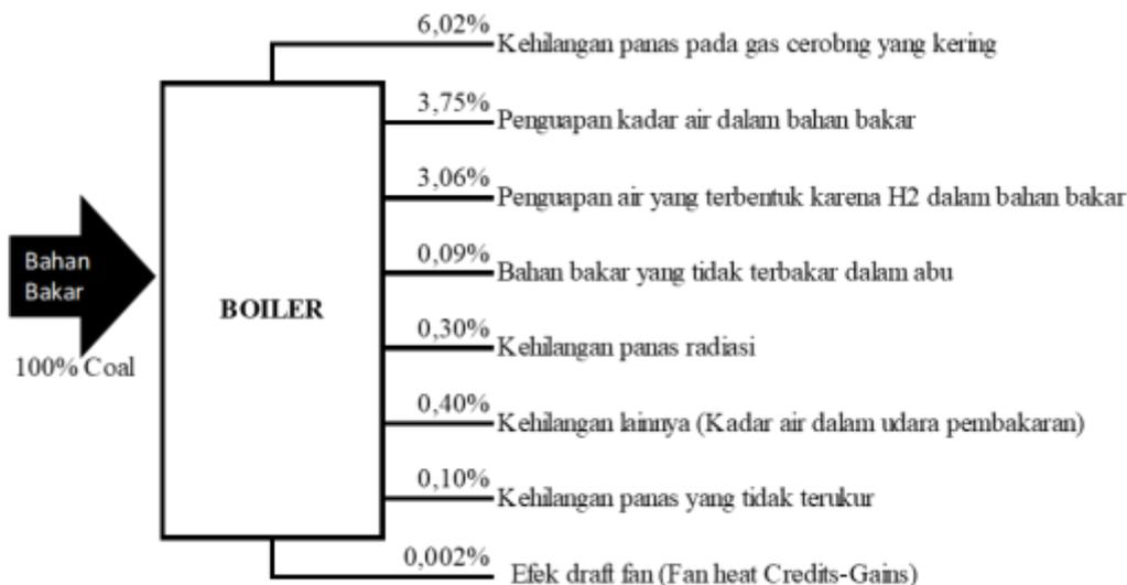
Tabel 5. Data analisa kehilangan panas yang digunakan untuk menentukan efisiensi boiler unit 2 dengan menggunakan metode tidak langsung pada kondisi operasi tanggal 6 Juli 2022 pada beban 66 MW dengan bahan bakar batubara 100%. Jadi efisiensi boiler ( $h$ ) in HHV ketika menggunakan bahan bakar batubara 100 % dengan metoda tak langsung adalah:  $= 100 - (i + ii + iii + iv + v + vi + vii + viii) = 100 - 13,73 = 86,27 \%$ .
